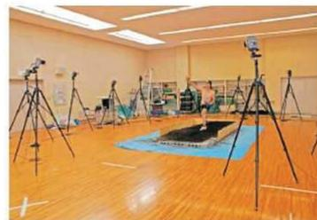
赤外線方式の高精度モーションキャプチャ装置 (Mac3DSystem) です。
