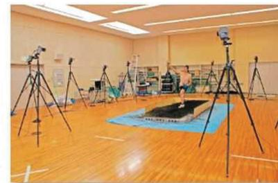
任意に設定された3次元空間内にある任意の位置座標を時間軸に沿って特定し、関節部位の各移動速度、加速度、角度等を出力するシステムです。
