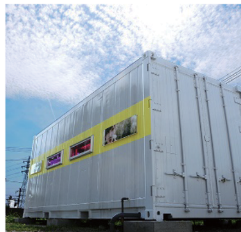
図 完全閉鎖型植物工場 20Ft 冷凍コンテナを 2 台接続し、液肥 2 系統、LED 調光 6 系統の試験区設定が可能。
