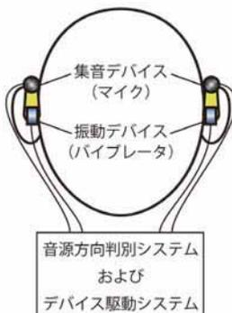
図1 補聴システムの模式図
