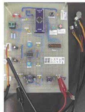
図3 駆動ユニット(試作)
