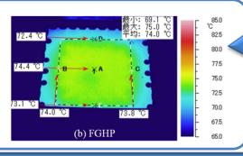
熱拡散性能に優れ、 発生した熱を速やかに拡散させ、ホットスポットを発生させないことによって、 熱源の温度上昇を 抑制!
