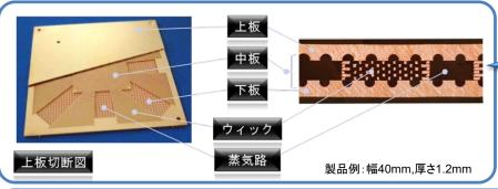
内部のウイック・蒸気路を 高精細エッチング技術を駆使 して形成することにより、内部 構造の精密な制御が可能!
