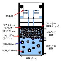
図2ファインセラミックスの精密成形装置
