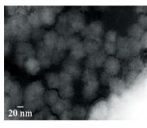
図3 金属水溶液中で合成したセリア ナノ粒子(白色です)
