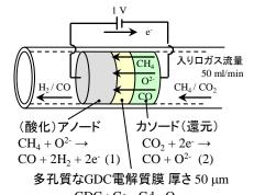
GDC: Ce<sub>0.8</sub>Gd<sub>0.2</sub>O<sub>1.9</sub> 全反応式 CH<sub>4</sub>+CO<sub>2</sub>→2H<sub>2</sub>+2CO (3) 図1 バイオガスの改質装置
