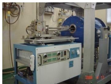
市販強磁場マグネットに組み込める世界初の小型X線粉末カメラシステム(トライ・エスイーとの共同開発)機能性材料の磁場中評価に利用(東北大設置)
